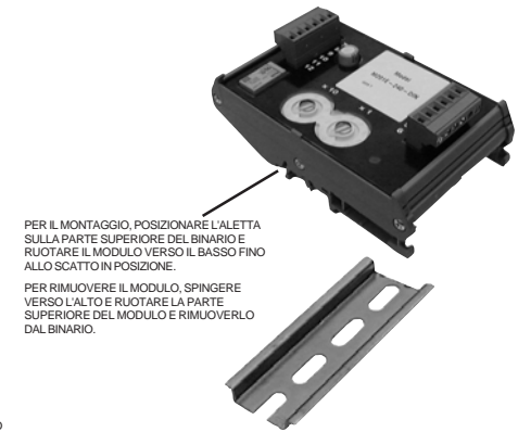
Figura 1b: Modulo di uscita montato su binario DIN M201E-240-DIN con contatti di relè da 240 V.
