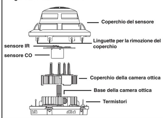
tipo di contaminazione e pertanto si consiglia la rimozione dei sensori prima dell'avvio di qualsiasi operazione, rimodellazione o altro intervento che produca polvere. È necessario rimuovere i coperchi antipolvere prima della messa in funzione del sistema.
